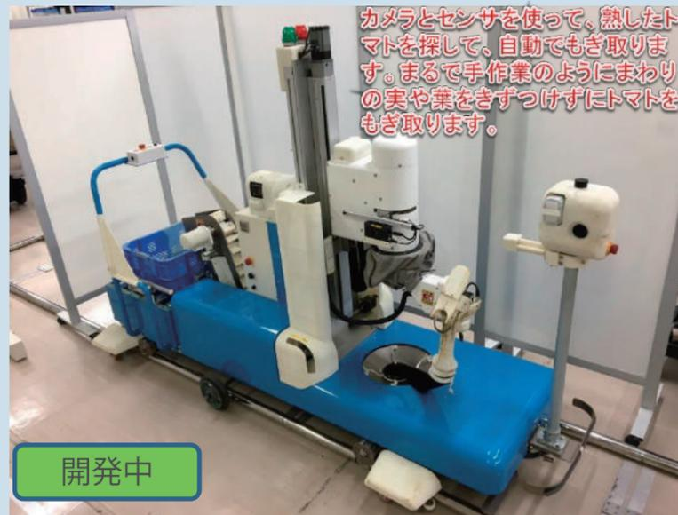
カメラとセンサを使って、熟したトマトを探して、自動でもぎ取ります。まるで手作業のようにまわりの実や葉をきずつけずにトマトをもぎ取ります。
