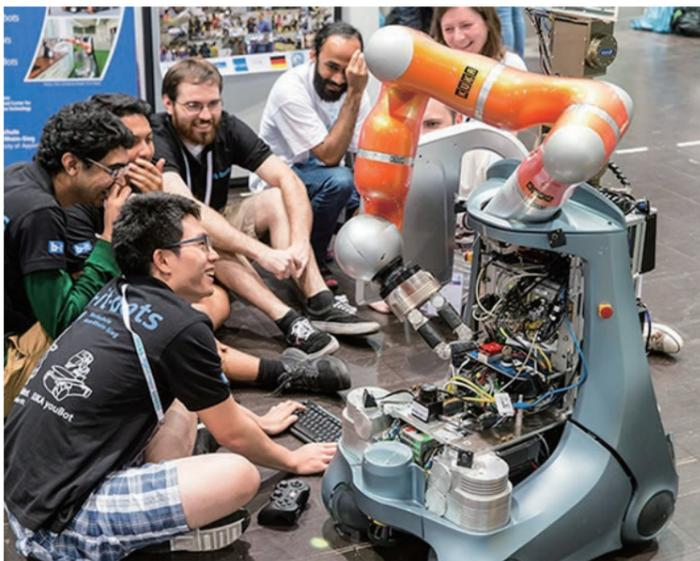
インダストリー4.0のスマート工場では、産業用ロボットアームを備えた移動ロボット「モバイル・マニピュレータ」が人間を支援すると考えられています。そんな将来を想定してロボット技術を競います。車輪などの移動機構を備えたロボットアームが部品を検知して回収、目的地へと運びます。
